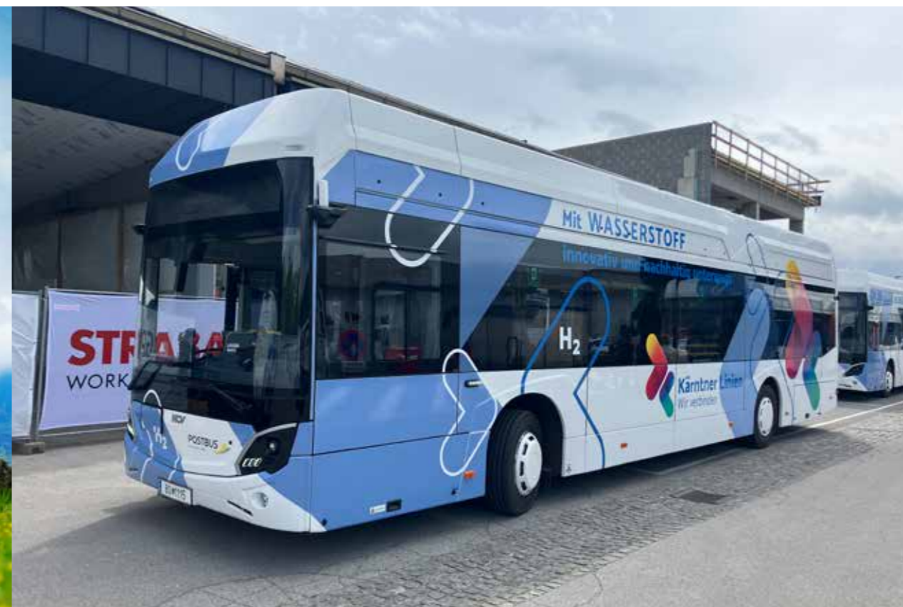
Niederflur-Überlandbus Typ MCV C127 FC LE der Österreichischen Postbus AG, ausgestattet mit elektrischem Antriebssystem VEDS 1.0 von Driventic.
